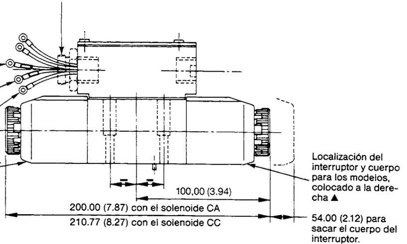
▲ Para los modelos LH colocado a la izquierda (vgr. DG 4 V-3\*AL--) las del solenoide y del interruptor se invierten.
