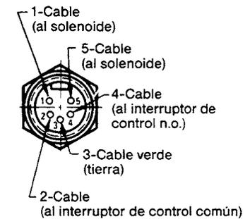
**Conector de 5 pins.** Se utiliza con válvulas de un solo solenoide (pág. 12) Designación en la referencia completa:
