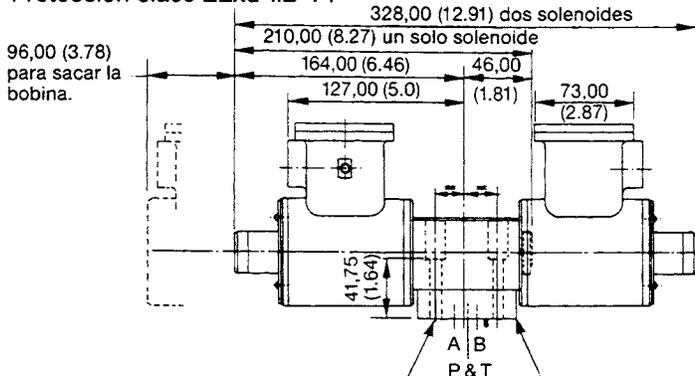
La bobina y la caja terminal pueden girarse por requerimientos de la instalación (sacar el tornillo, girar la bobina y volver a apretar el tornillo ▲)
