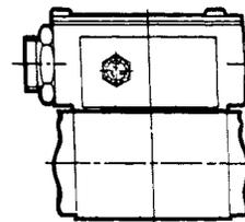
P = bobinas enchufables para facilidad de cambio sin desconectar los cables
