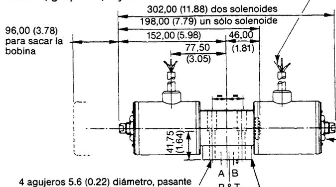
Longitud 1 m (40") cable recubierto aprobado por UL/CSA. Tierra color verde. Conexiones del solenoide a otros 2 cables (colores no especificados)
